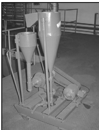
Figura 3 – Equipamento Afunda- Flutua que usa suspensões na separação.
