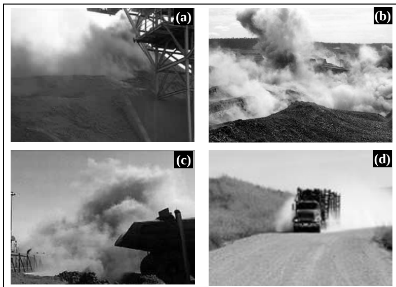
Figura 3 – Atividades da mineração com consequente geração de poeiras. (a) Ponto de transferência de minério de ferro; (b) Explosão em uma mina de carvão; (c) Transporte e formação de pilhas de carvão; (d) Transporte em estradas não pavimentadas.
